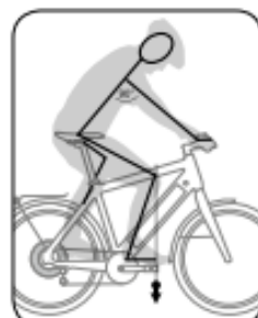
Knie muss über der Achse des vorderen Pedals stehen
